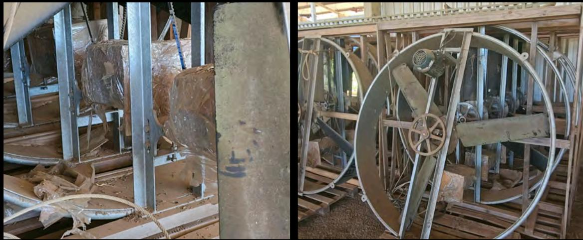
LOTE M30-B – 4 VENTILADORES DELAVAL DCF78BR – NOVOS, NA CAIXA – TRIFÁSICOS – VENTILADORES DE 2 METROS (OS MAIORES DO MERCADO) – MOTOR HÉRCULES POTÊNCIA 1,5CV - ÁREA DE ATUAÇÃO DOS VENTILADORES 18 METROS POR 8 A 12 METROS LATERAIS, SEGUINDO AS INSTALAÇÕES DO MANUAL
